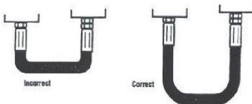
FIGURE 3 — MINIMUM BEND RADIUS
